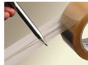
PVC-Träger sind reißfester und stärker belastbar
